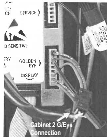
Photo 1 – À LA CARTE Golden Eye connection in a host SNACK machine
